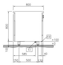
Electrical inlet (power) EQ Equipotential screw
